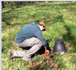
Pose de l'appareil (Tromino®) au sol pour l'enregistrement du bruit sismique ambiant pendant 20 minutes.
